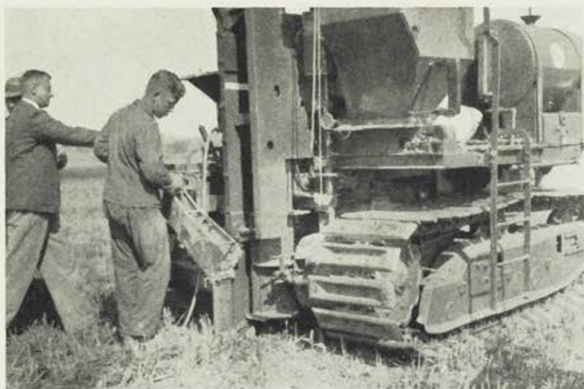
Abb. 2 Rückansicht des Rohrpflegs von Prof. Dr. Janert. (Aufn. Fluck)
