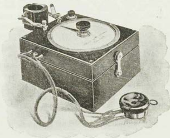
Fig. 1. Äußere Ansicht der für Bodenaufnahmen im freien Felde angepaßten Wheatston'schen Brücke.
